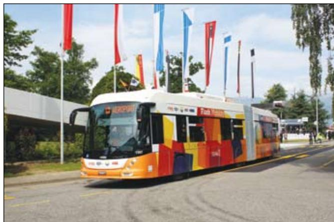
**Genève (TPG):** L'autobus électrique de démonstration Tosa, numéroté 1397, quitte Palexpo en direction de l'aéroport, le 28 mai 2013. Derrière le véhicule on distingue le portique soutenant le rail d'alimentation pour la recharge énergétique du véhicule. Photo extraite de Tram n° 115, page 73. Prise de vue: Nicolas Cominoli
